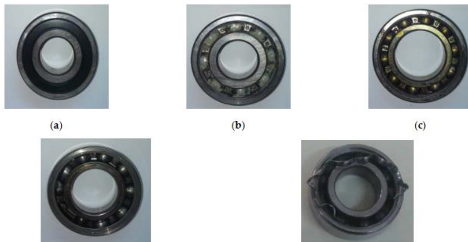
Различные стадии дефекта подшипника
