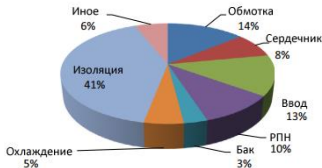
Распределение повреждений по компонентам трансформатора
